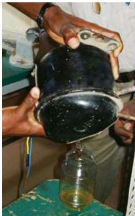
شکل ۱۴: تخلیه روغن از کمپرسور هرمتیک
