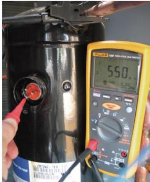
شکل ۱۲: ارایش آزمایش IR در یک کمپرسور AC پیچشی هرمتیک
